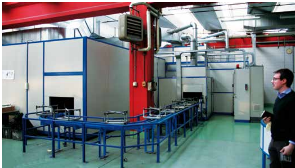
11 – El equipo para la aplicación del transparente en piezas tras la aplicación física del metal, que se utiliza cuando resulta necesaria.
