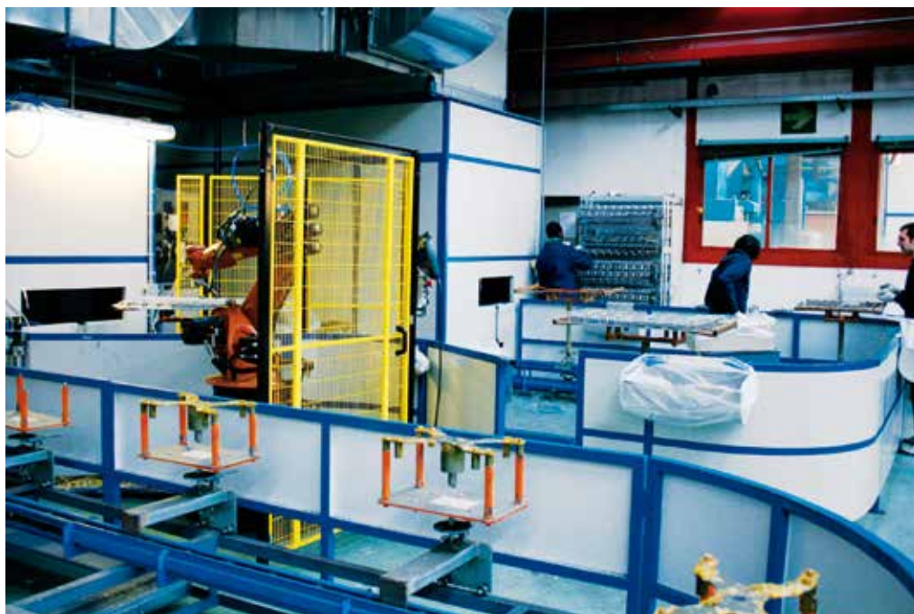
6 – Una de las dos plantas de aplicación robotizada del fondo UV, que constan de zona de carga, cabina robotizada de aplicación, preevaporación, horno IR + UV, zona de enfriamiento y descarga. Las piezas se transportan en bandejas.
